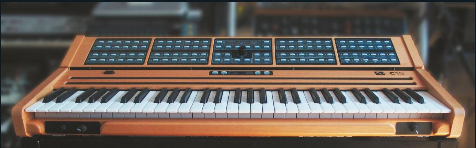
Die Bedienoberfläche des knapp 4.000,- Euro teuren C15 ist zweigeteilt. Der obere Programmiereteil besitzt Taster für alle Parameter sowie einen Encoder und ein Display zur Editierung. Er lässt sich leicht abmontieren. Übrig bleiben das Keyboard mit Realtime-Controllern und allen Anschlüssen sowie einige wenige Bedienelemente zum Abruf der Presets und damit alles Notwendige zum Live-Spiel.
